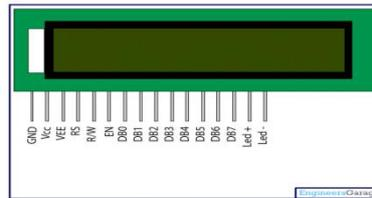
Fig. 2 LCD Display
